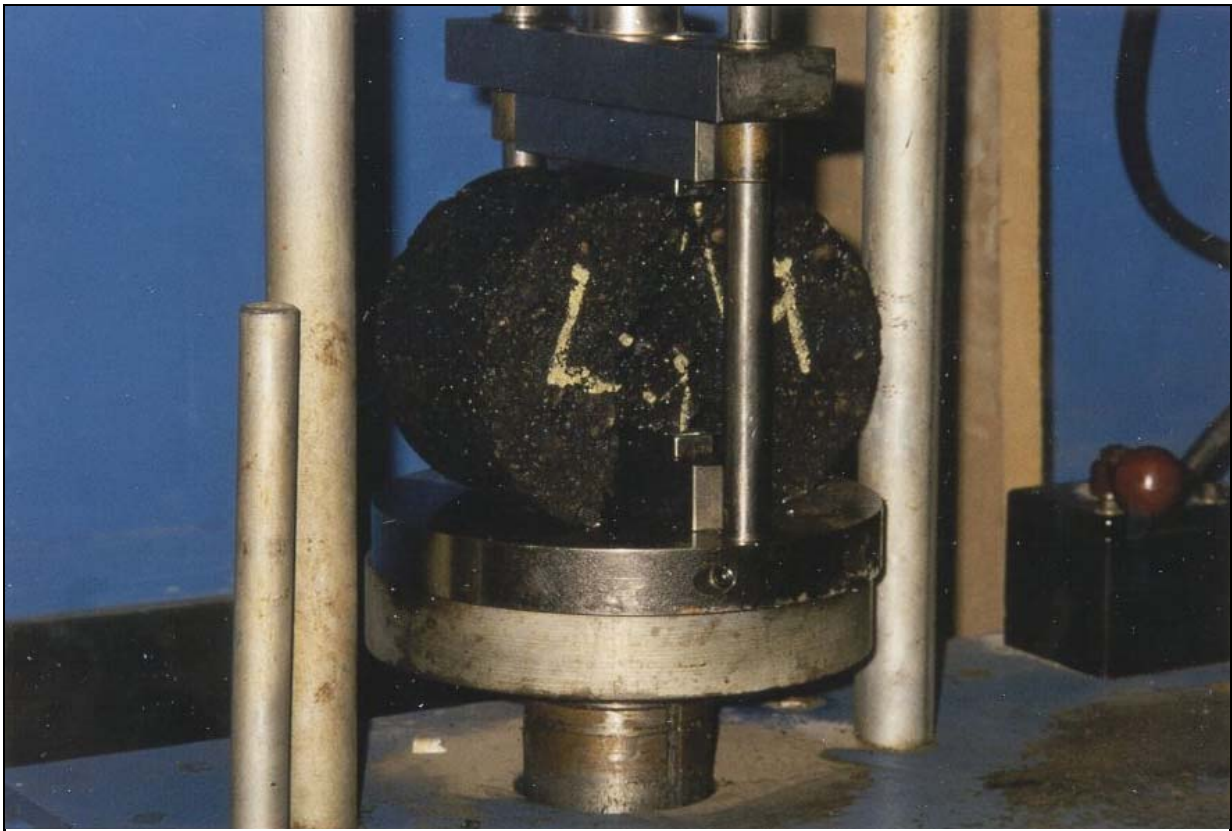
Rupture d'un spécimen lors d'un essai de résistance à la traction indirecte
