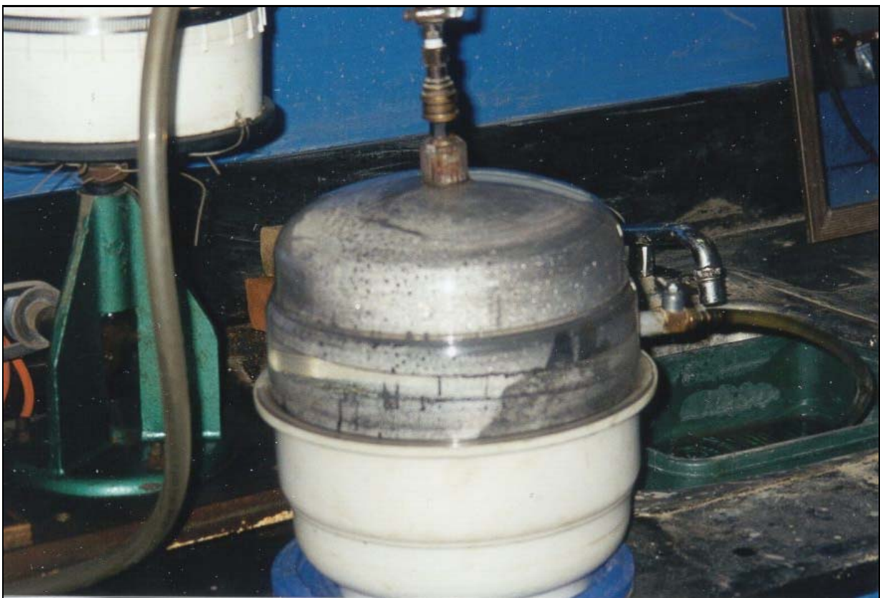
Saturation sous vide en cours, en utilisant un pycnomètre de type F.
