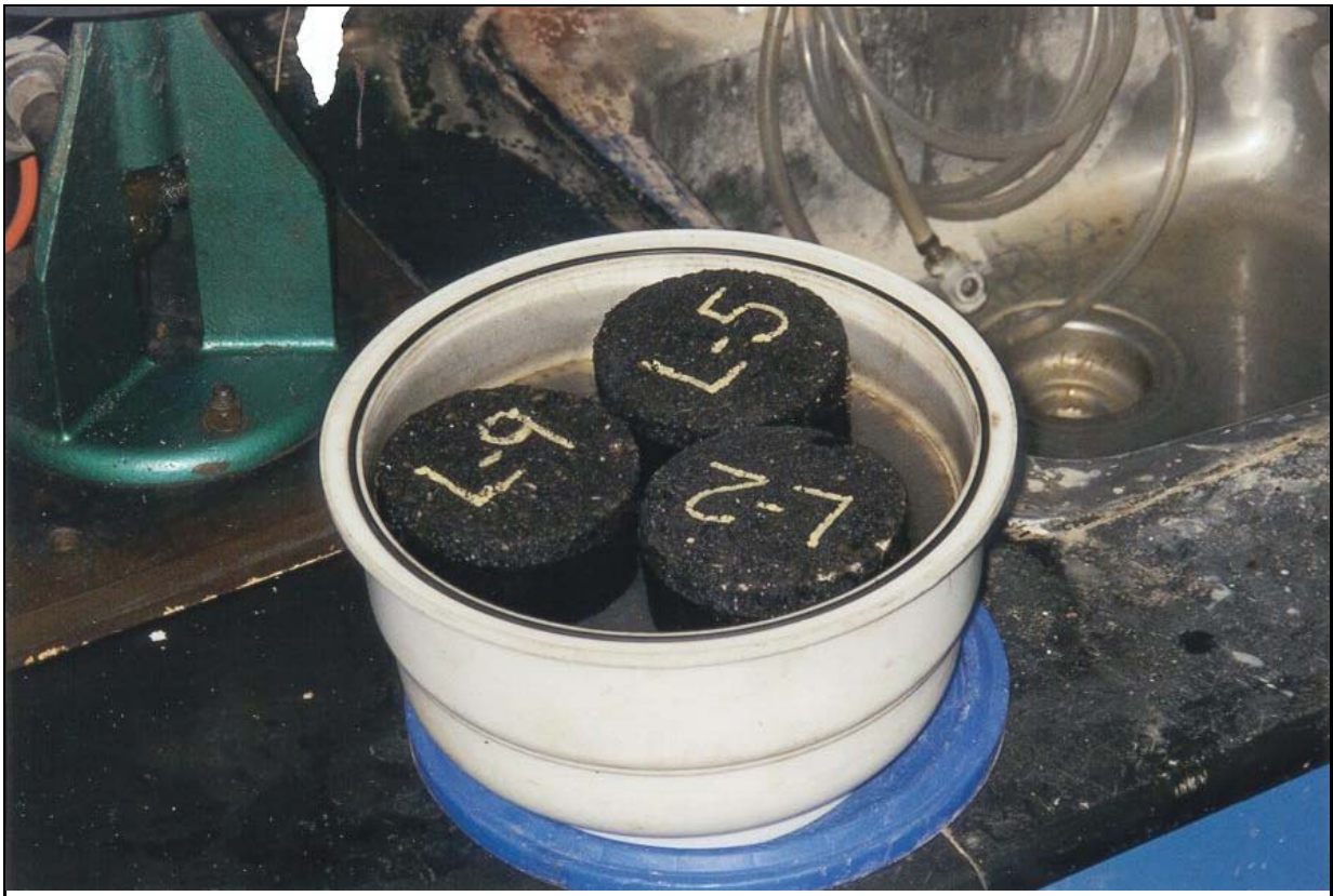
Spécimens conditionnés préparés pour la saturation partielle sous vide (méthodes MTO, ASTM et AASHTO)
