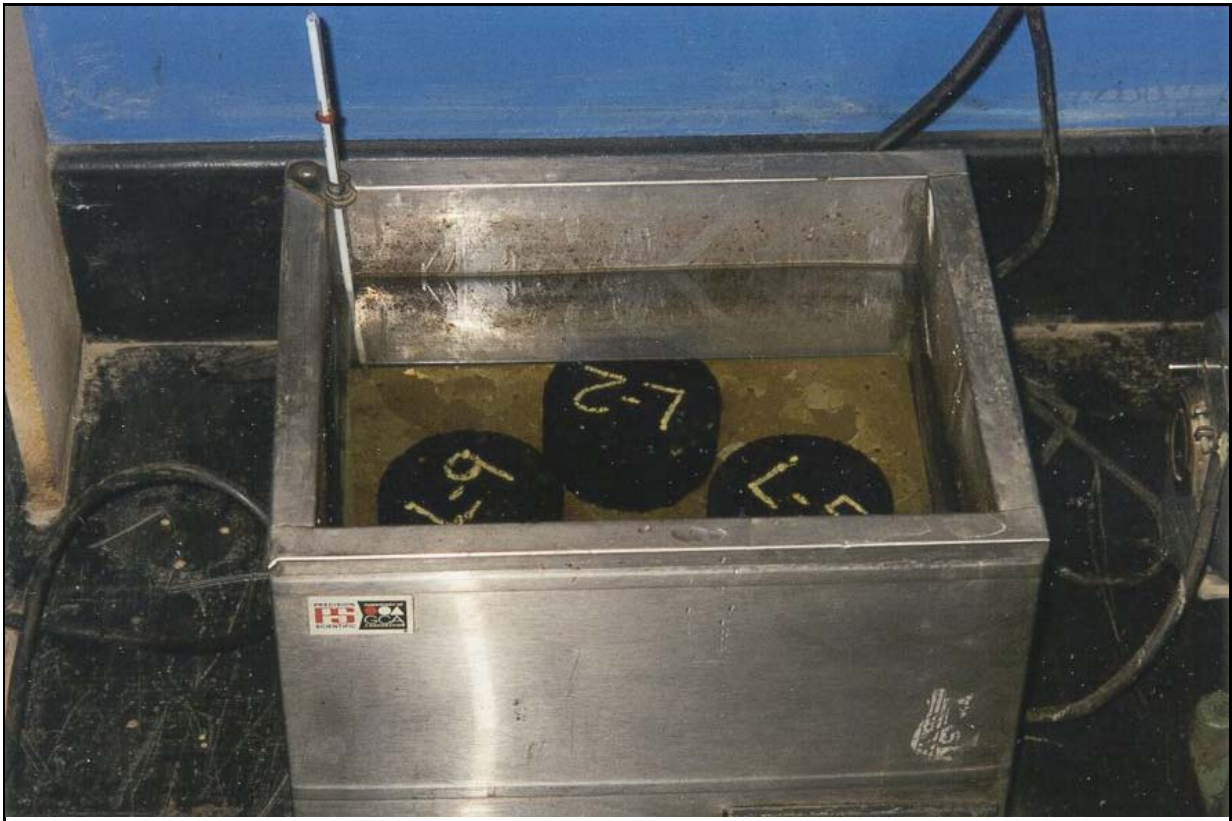
Spécimens conditionnés dans un bain d'eau à 60 °C (toutes les méthodes)
